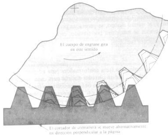
Figura 1.9.2 Cortador en forma de cremallera.
