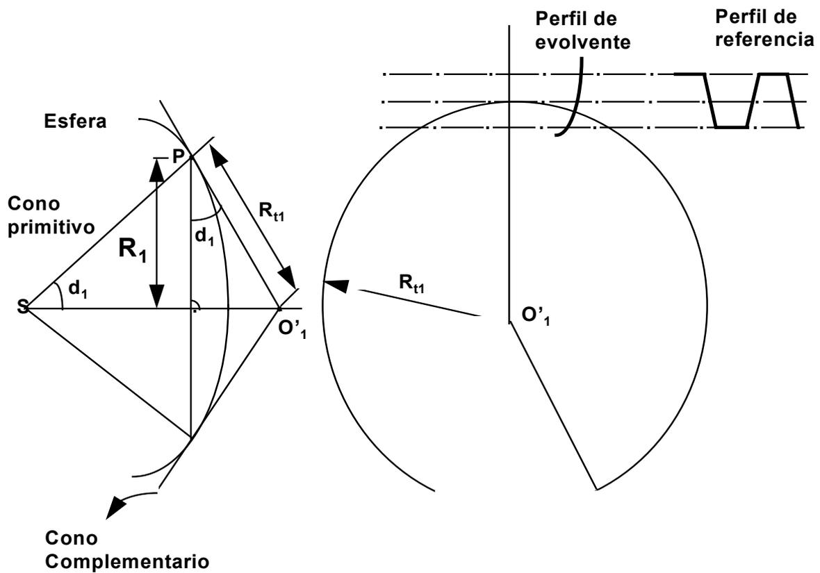
Para estudiar en el plano la geometría proyectada sobre la superficie esférica, se realiza la llamada **construcción de Tredgold** que consiste en proyectar sobre un cono complementario exterior, tangente a la esfera en la misma circunferencia de corte con el cono primitivo, el propio trazado de la circunferencia. Posteriormente, esa proyección sobre el cono exterior se desarrolla y representa de forma aproximada toda la geometría, se calcula el número de dientes equivalente etc.
