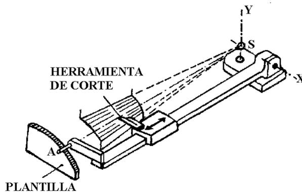
En el otro extremo, el seguidor A recorre la plantilla que tiene el perfil de evolvente en su trazado. El diseño de la máquina es tal que la trayectoria de la herramienta de corte coincide con la línea SA.
