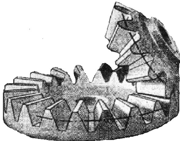
La generación de los flancos de los dientes se realiza ahora al hacer rodar sin deslizar un cono generador sobre un plano que secciona por un diámetro mayor a la esfera K.
