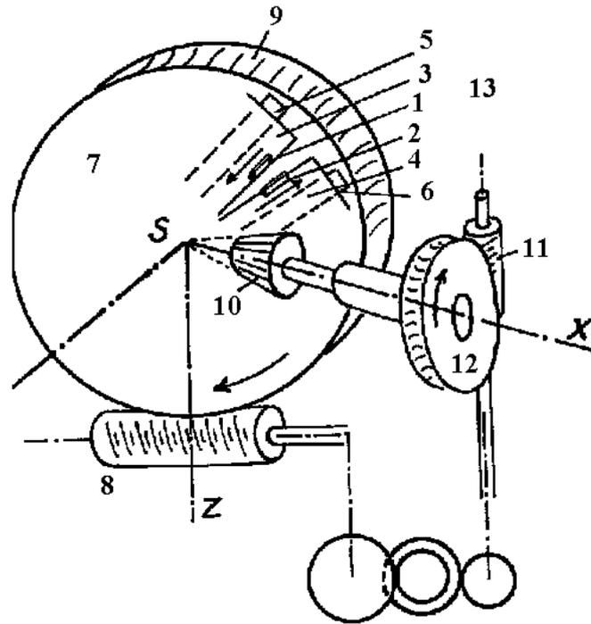
Las dos herramientas de corte 1 y 2 están montadas sobre dos guías 3 y 4 que se deslizan en movimiento alternativo y opuesto sobre las correderas 5 y 6, que son orientables al girar el soporte 7. Este soporte 7 gira en torno a su eje horizontal Y. El movimiento de giro del soporte está relacionado con el de la rueda cónica que estamos tallando (10) mediante una cierta relación cinemática representada por el tren de engranajes.
