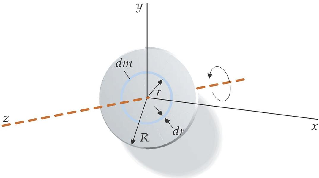
6. Determinar el momento de inercia de un cilindro macizo de densidad volumétrica de masa  $\rho$  (radio  $R$  y masa  $M$ ) alrededor de un eje de rotación perpendicular al plano del disco y que pasa por su centro.
